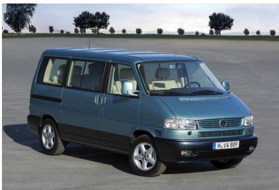
Der T4 war der erste Bulli mit Frontmotor und -antrieb.
