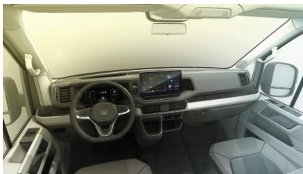
Les éléments de commande des fonctions d'éclairage ont été redessinés et réagencés, tout comme les claviers au niveau de la console centrale et l'ensemble des diffuseurs d'air.
