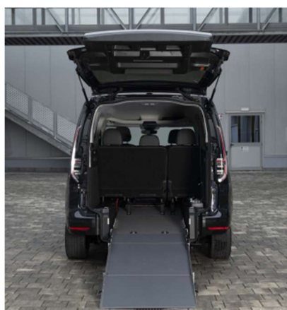
L'abaissement du cadre-plancher et le montage d'un bac spécial antidérapant permettent d'atteindre une hauteur d'habitacle de 140 cm.
