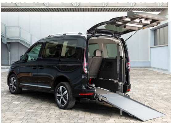
L'accès de la personne en fauteuil roulant à l'intérieur du véhicule s'opère facilement par une rampe pop-up pliable à l'intérieur.
