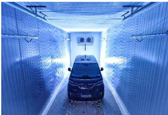
Standardisierter Test in der Kältekammer: Wie lange dauert es bei minus 20 Grad, bis das Sichtfeld des Aussenspiegels frei ist?
